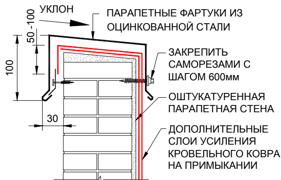
Рис. 26 Примыкание кровельного ковра к парапетной стене высотой менее 500мм.
